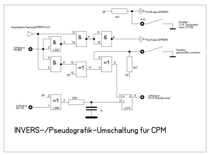
Für eine Realisierung dieser Änderung mit SMD kann folgender Aufbauvorschlag Verwendung finden. Der "Turmaufbau" wird anstelle des ZG-Eproms eingesetzt. Von der Platine führen drei Leitungen zu Punkten auf der Hauptplatine sowie zwei Leitungen zu Schaltern.
